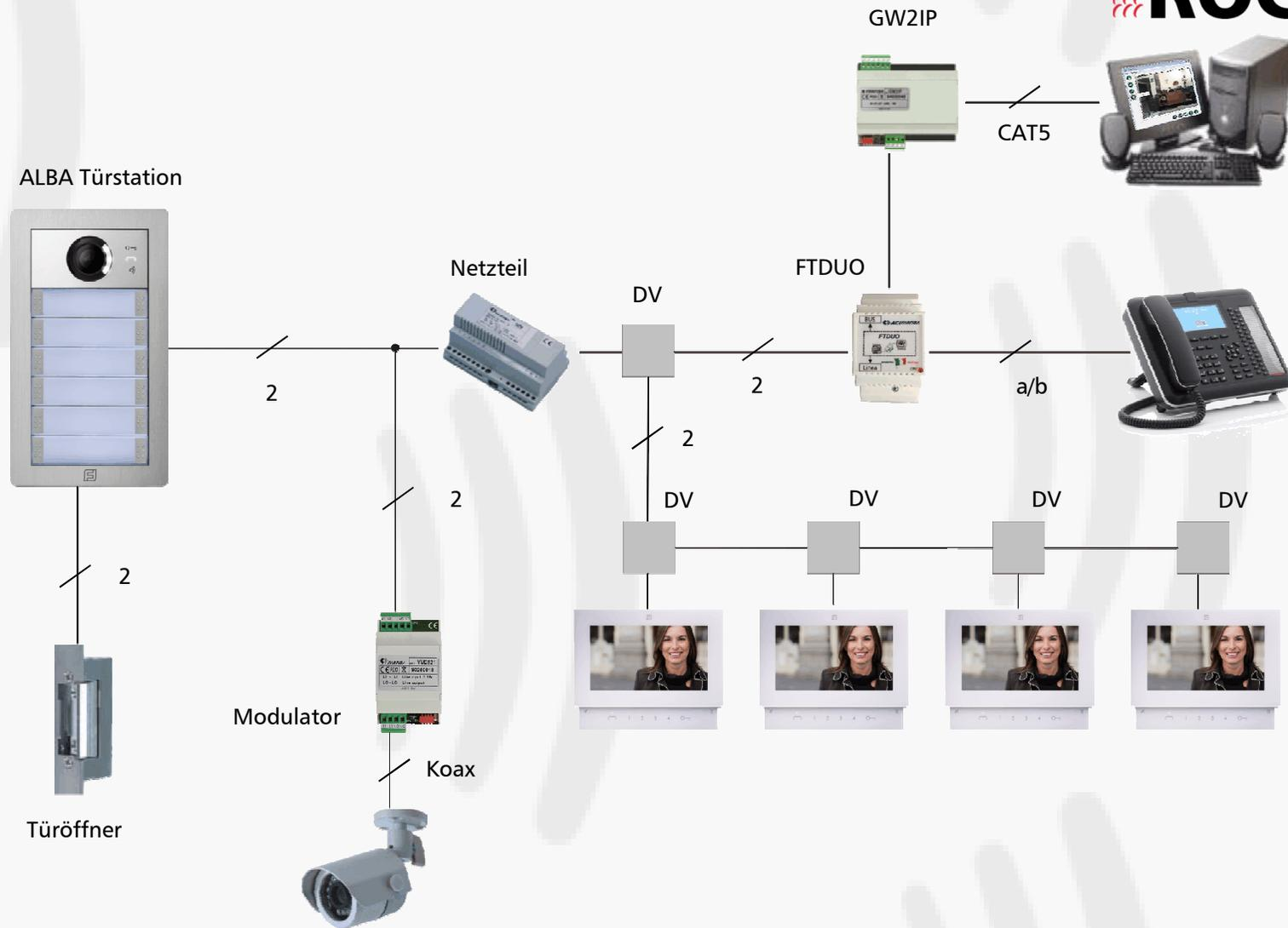
Hybride Videosprechanlage mit Setze Videohaustelefone und TK-Anlagen-Integration über a/b und/oder IP SIP.
