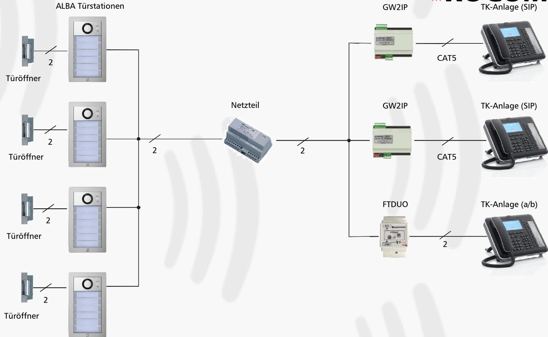
Mehrere Türstationen (max. 20) an mehreren TK-Anlagen (max. 200) über a/b oder IP/SIP, gemischter Betrieb
